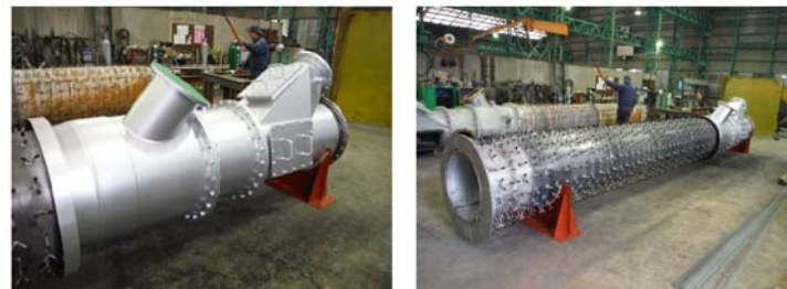
製品例：燃料一次空気接続部と全景(耐火材施工前)
